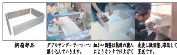
桐部材加工 矩形組み手接ぎの接合前 矩形組み手接ぎの接合後 最後に前板を取りつけて完成です。
